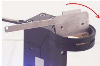
Abbildung 5: Lösen des Objektiv-Einsatzes mit der breiten Seite des Flachschlüssels
