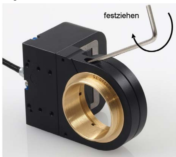
Abbildung 9: Befestigen des Mikroskop-Gewindeeinsatzes mit dem Sechskantschlüssel (hier ohne Mikroskop)
