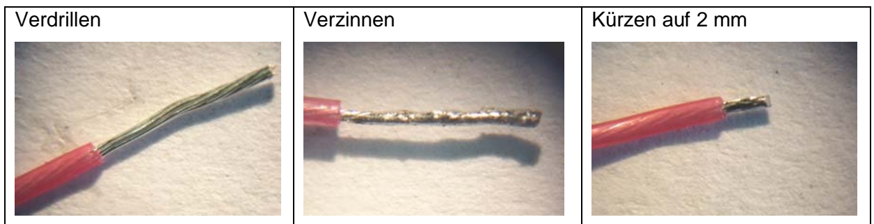
Abb. 5: Vorbereitung der Litze
