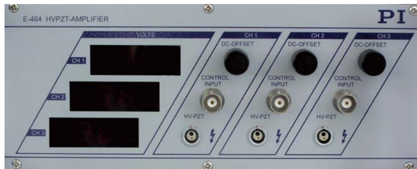
Abbildung 2: Vorderseite des E-464 mit Bedienelementen
