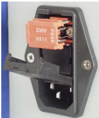
Abbildung 3: Lage der Netzsicherungen und des Trägers, nur eine von zwei Sicherungen ist sichtbar
